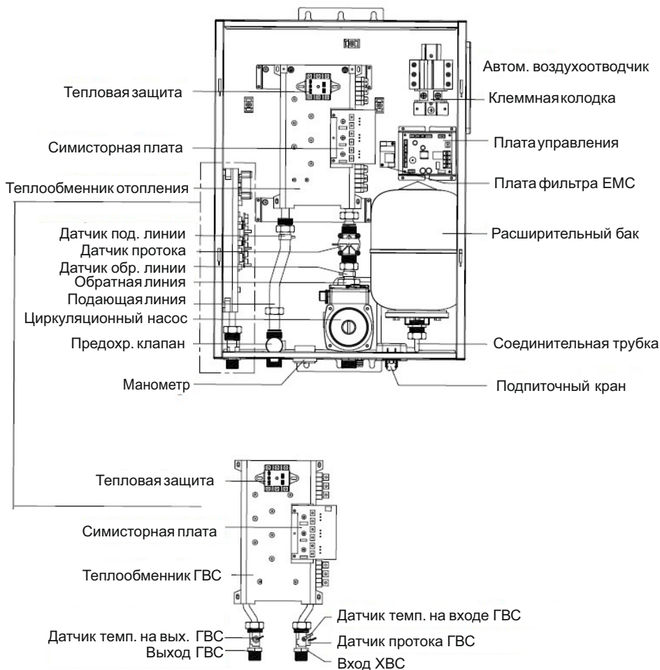
Рис. 2. Схема внутреннего устройства изделия
