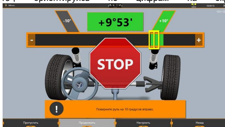
Правильный угол поворота подтверждается зеленым цветом цифр на экране монитора и появлением знака «СТОП». ПМО в автоматическом режиме запоминает нужные значения и на экране монитора появляется шкала с индикатором для поворота колес в центральное положение.
