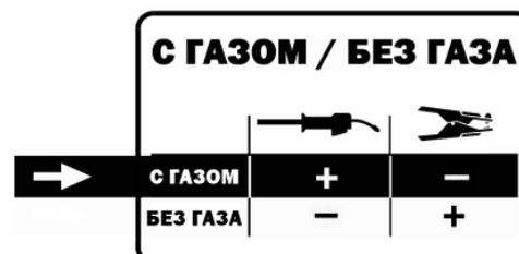
**Подсоединение кабеля заземления:**
