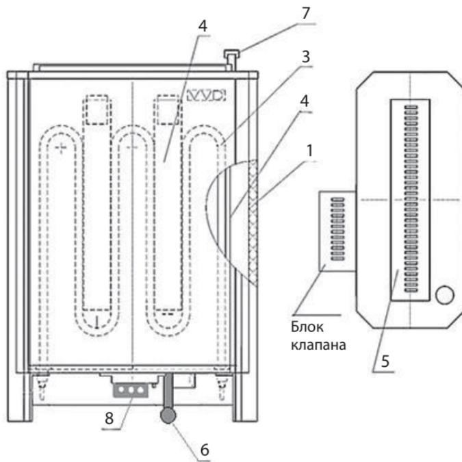
**Рис. 2** Устройство Автономного ЭГПП 3,9-6,0 кВт
