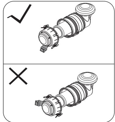
**Воздушный фильтр является важным элементом двигателя. Запрещается модифицировать его конструкцию или использовать другие фильтрующие элементы.**
