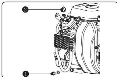
(б) Установите на место спускную пробку и залейте масло. Закройте крышке масляного бака.
