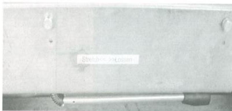
Рычаг ослабления натяжения ремня
