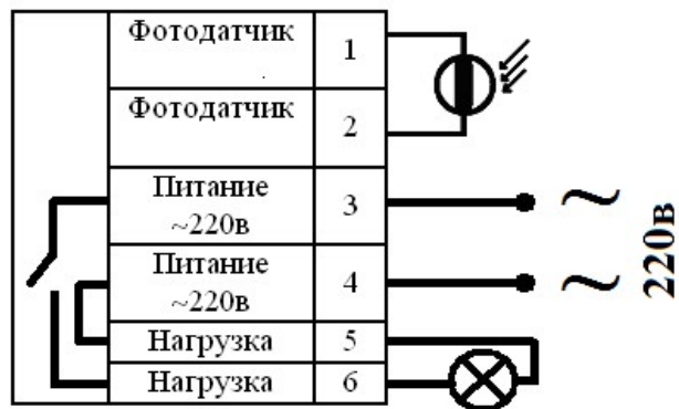
Рис. 2. Типовая схема подключения фотореле к сети 220в.
