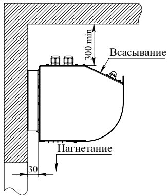
ГОРИЗОНТАЛЬНАЯ УСТАНОВКА к стене с помощью кронштейнов
