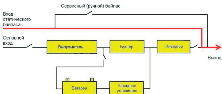
Схема работы в режиме неисправности
