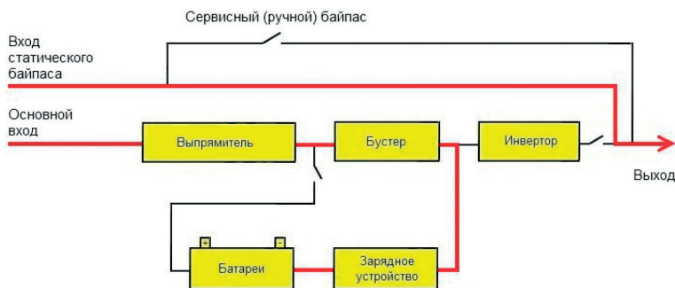
Схема работы в режиме статического байпаса
