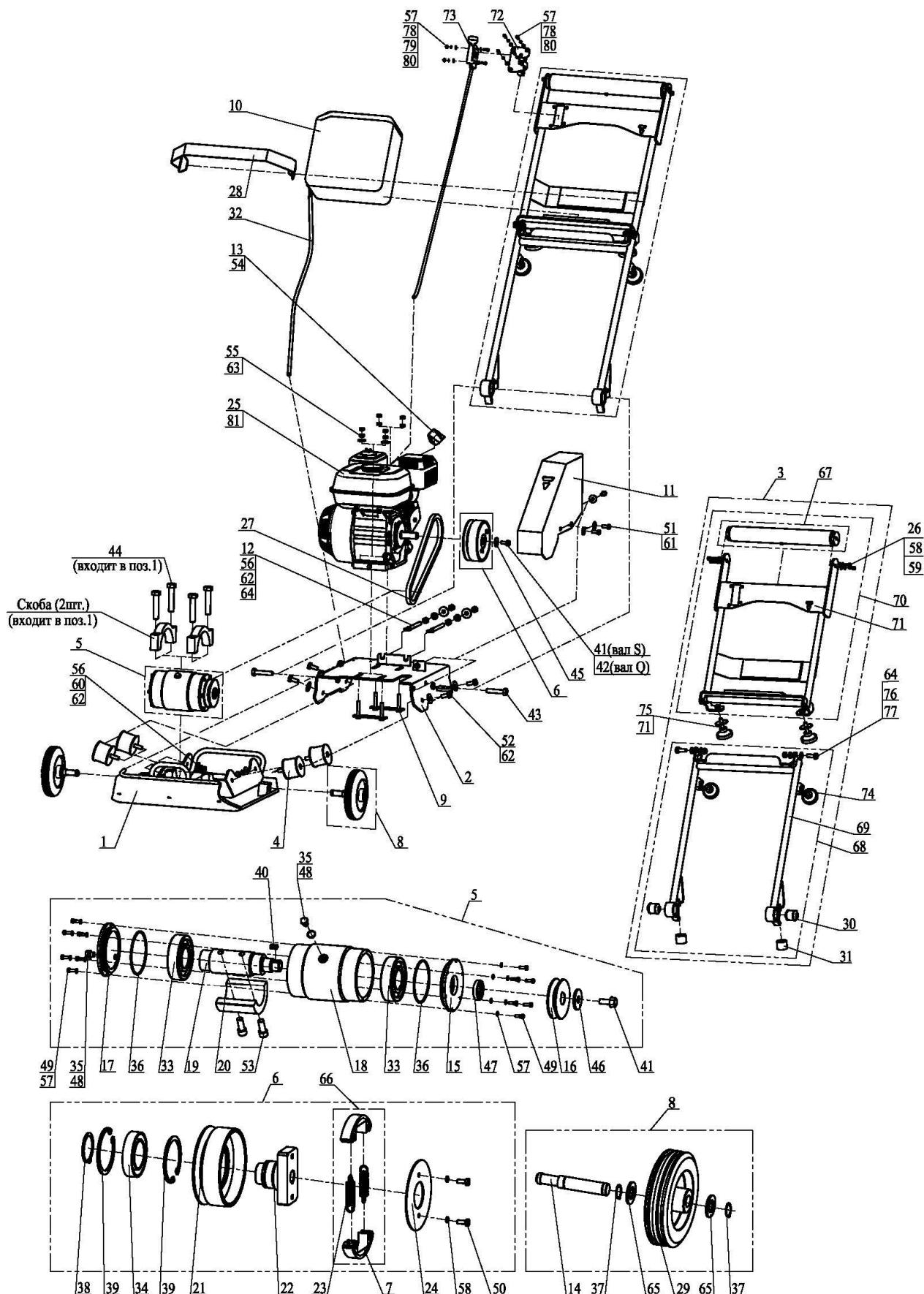
Рисунок 9 – Компоновка виброплиты
