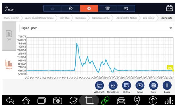
Рисунок 5-20 Пример экрана ПИД-графика
