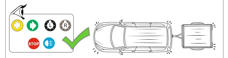
После монтажа проведите проверку правильности присоединения электропроводки нагрузочным стендом или подключением прицепа.
