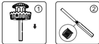
Проверьте его на загрязнения. При необходимости очистите под проточной водой. Чтобы установить держатель обратно, сначала проверьте, не выпала ли пружинка. На пружинку установите фильтр, далее поднесите держатель фильтра к отверстию в увлажнителе, проследите, чтобы фильтр точно попал в это отверстие, и закрепите держатель до упора.
