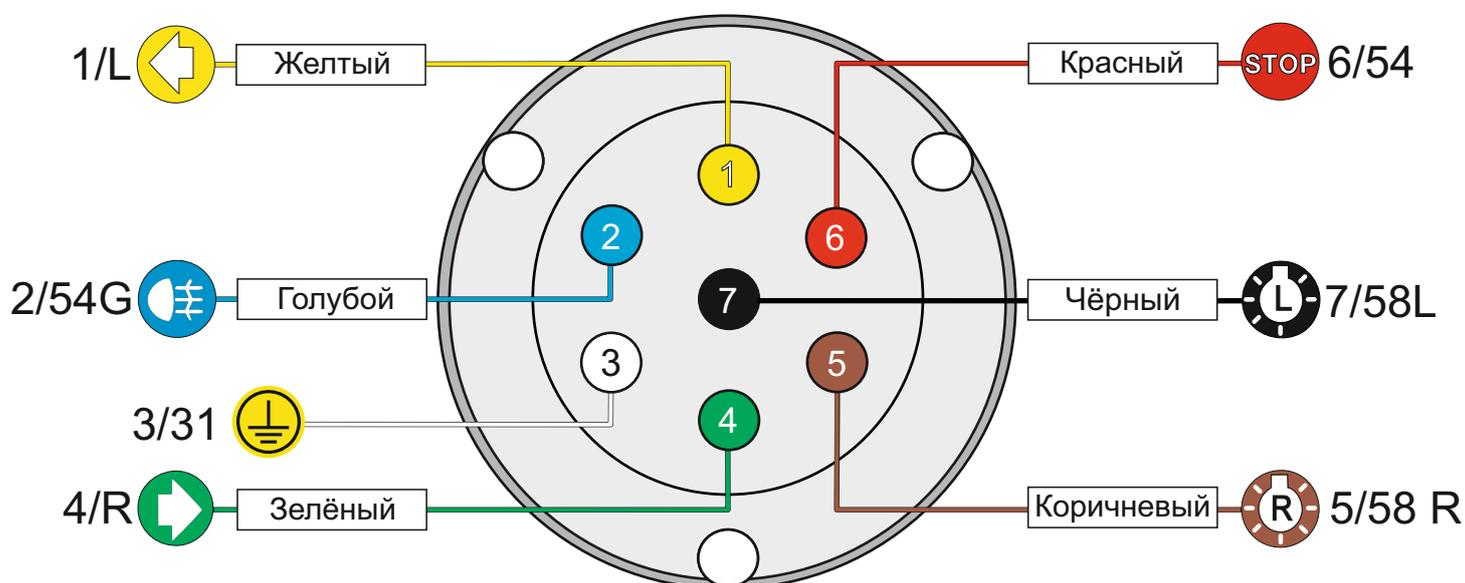
**После монтажа проведите проверку правильности присоединения электропроводки тестером с нагрузкой или лампами соответствующей мощности.**
