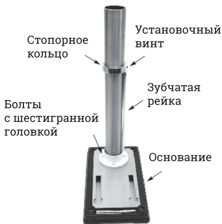
Рис. 2. Установка стойки в сборе на основание
