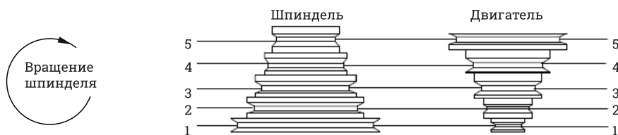
Рис. 12. Регулировка частоты вращения шпинделя
