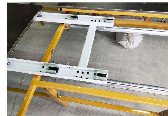
Механизм подвижной каретки с направляющими и подшипниками
