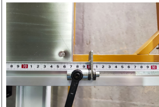
Линейка перпендикулярного упора с флажками для выставления точного размера реза детали.
