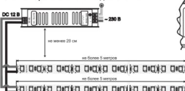
Светодиодная лента 12 В подключается последовательно не более 5 метров. При подключении большей длины используйте параллельное подключение.
