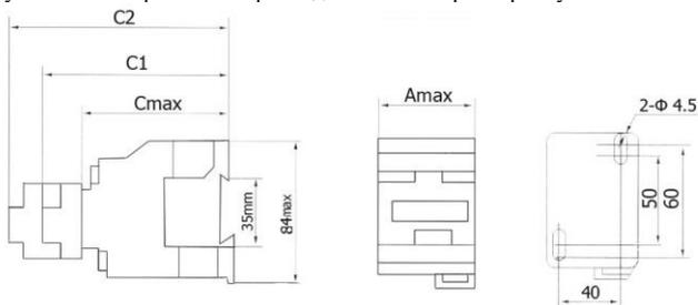
Рисунок 4 - Габаритные и присоединительные размеры пускателей 40-95А
