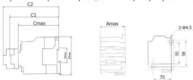
Рисунок 3 - Габаритные и присоединительные размеры пускателей 16-40А
