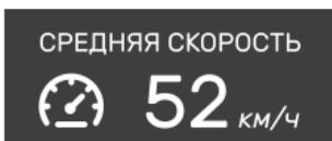
Поэтому на всем протяжении такого участка отображается средняя скорость автомобиля в реальном времени, а в основном блоке слева – расстояние до окончания участка контроля.
