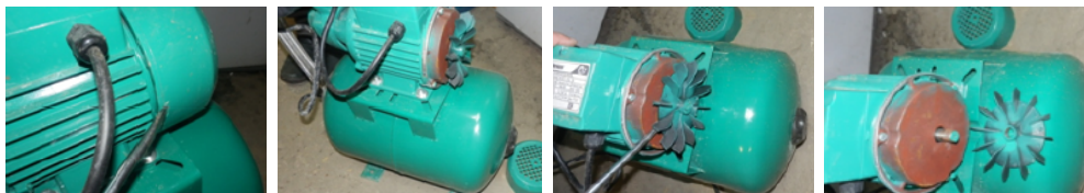
Рисунок 4. Снять вентилятор с помощью шлицевой отвертки.
