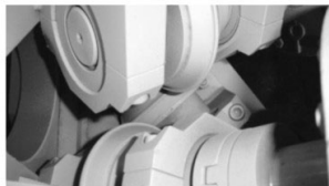
Вращаясь, рабочие ролики деформируют трубу и придают ей вращательно-поступательное движение.
