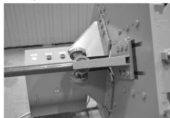
Заготовка (труба) через приемный лионет вводится между тремя рабочими роликами.
