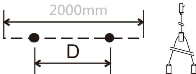
2. Соедините Y-образное крепление с тросом, который закреплён к потолку. Зафиксируйте светильник (как указано на схеме) и подсоедините питание 220В.
