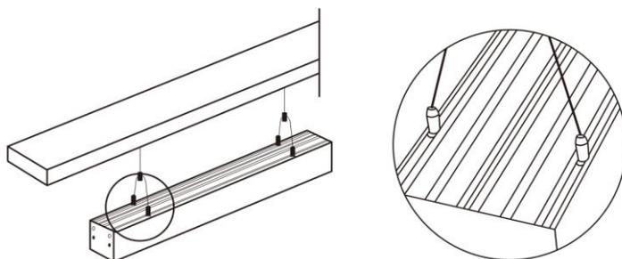
3. Чтобы выровнять светильник и отрегулировать длину нужно нажать на нижнюю часть замка крепления троса.
