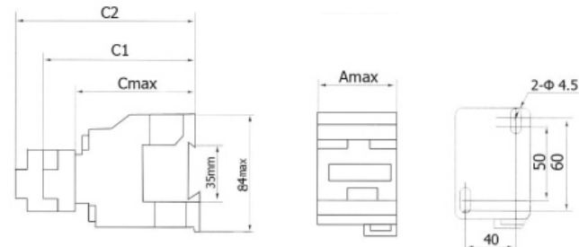
Рисунок 1 – Габаритные и присоединительные размеры пускателей 9 -12А
