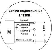
Электросхема подключения вентиляторов
