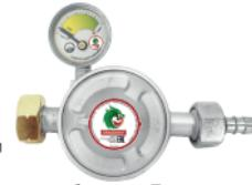
2. Присоедините газовый шланг к штуцеру регулятора. Используйте воду или жидкое мыло в качестве смазки, при присоединении шланга. Плотно присоедините шланг и закрепите его с помощью хомутов. Если регулятор оснащен резьбовым креплением вместо штуцера, то прикрутите гайку на шланг руками, а затем плотно затяните, используя гаечный ключ.
