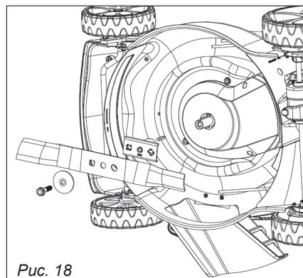
Для замены ножа наклоните газонокосилку на бок так, чтобы карбюратор оказался сверху.
