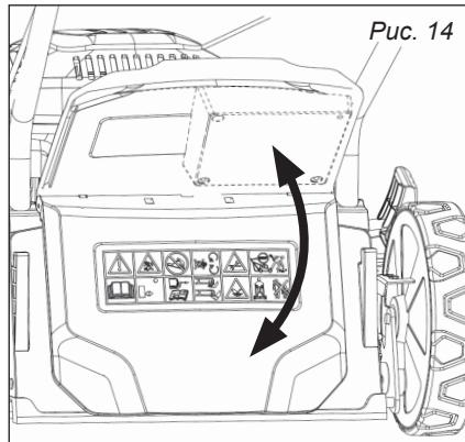
В положении закрытой задней крышки заглушка для мульчирования заблокирует разгрузочное отверстие.
