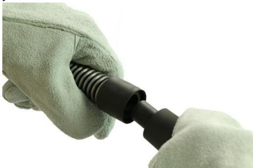
2. Снимите и выбросьте заглушку конца кабеля (для нового аппарата). Вытяните кабель из барабана, чтобы пропустить его через направляющий шланг и блок автоподачи.
