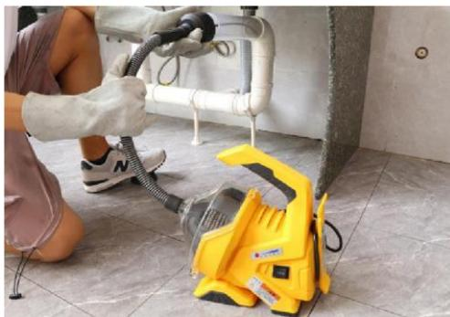
4. Переведите переключатель FOR/OFF/REV в положение FOR (вперед). Не нажимайте пока на ножной переключатель. За исключением случаев, четко оговоренных в данной инструкции, не вращайте кабель в обратном направлении. Работа аппарата для прочистки канализационных труб в направлении REV (назад) может привести к повреждению кабеля.
