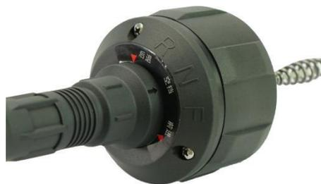
Убедитесь, что кабель не менее чем на 0,3 м находится в сливе, а конец блока автоподачи находится на расстоянии менее 6" (15 см) от сливного отверстия. Нажмите на ножной выключатель для запуска машины. Для продвижения кабеля в слив нажмите на рычаг подачи ADVANCE.
