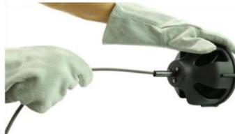
7. Установите барабан в аппарат. Поворачивайте барабан, пока он не встанет на место.
