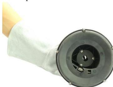
4. Отсоедините конец кабеля от задней части барабана. Полностью извлеките кабель из барабана.
