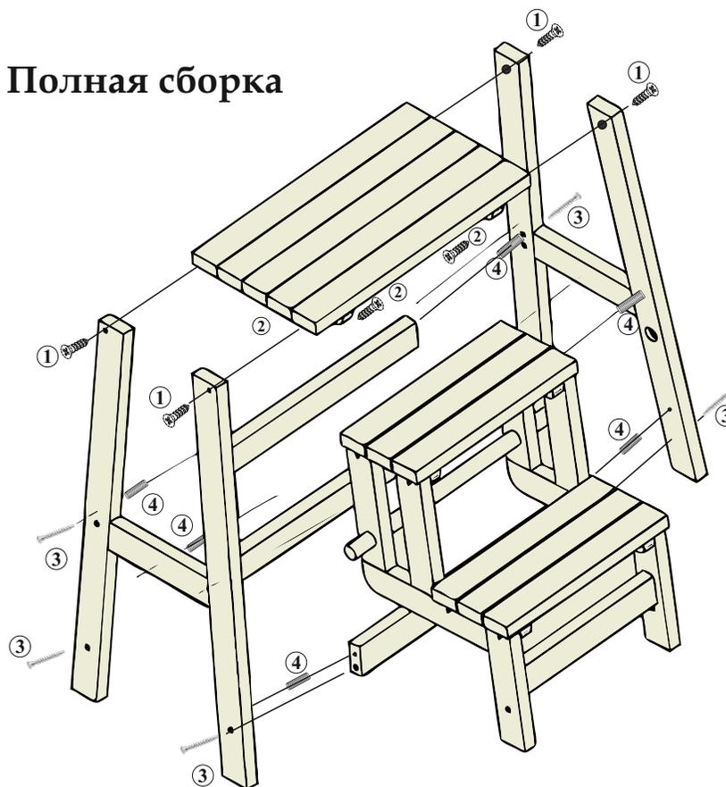
3. Отцентрировать поворотную часть между боками табурета и зафиксировать её саморезом 3,5x25.
