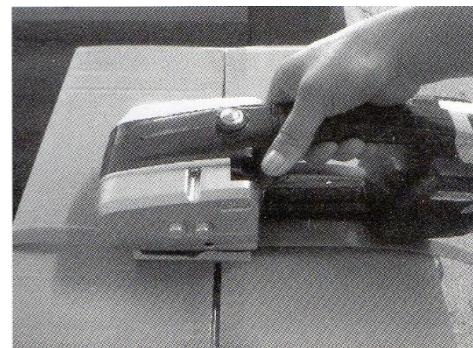
5. После окончания спаивания, светодиод мигает в течение примерно, двух секунд. Не снимайте инструмент с ленты в это время.
