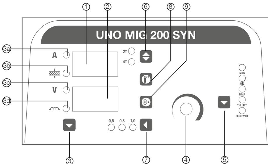
1. **Цифровой дисплей сварочного тока:** отображает установленные значения тока и толщины металла в режиме настройки. В режиме сварки отображает фактические значения сварочного тока.
