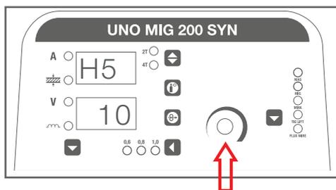
4. Повторным нажатием на кнопку выбора параметра. На верхнем дисплее отображается «Ant» - это «Antisticking» - служит для предотвращения приваривания электрода к детали.
