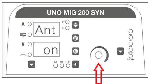
6. Далее повторным нажатием на кнопку выбора параметра. На верхнем дисплее отображается «AF» - это «arc force» - служит для стабилизации процесса, снижая вероятность обрыва сварочной дуги.
