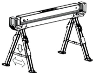
6. Опустите защелку регулировки высоты, а затем нажмите вниз, чтобы выдвинуть ножки в нужное положение. Убедитесь, что штифт на рычаге блокировки ножек надежно зафиксирован в одном из верхних отверстий на ножках. Все ножки должны быть зафиксированы одновременно. Поднимите защелку регулировки высоты, чтобы зафиксировать высоту ножек.
