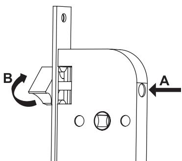
2. Нанесите разметку и сделайте выборку под корпус и лицевую планку в торце двери. На дверном полотне сделайте отверстия под цилиндровый механизм и квадрат ручки. После установите корпус замка в дверь и закрепите его саморезами.
