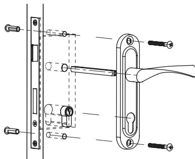
5. По установленному замку отметьте место установки ответной планки на дверной коробке. Сделайте пазы под защелку и ригели. Закрепите ответную планку при помощи саморезов.
