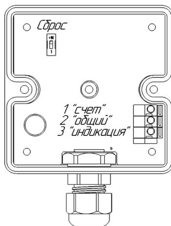
Рис. 1 Схема подключения
