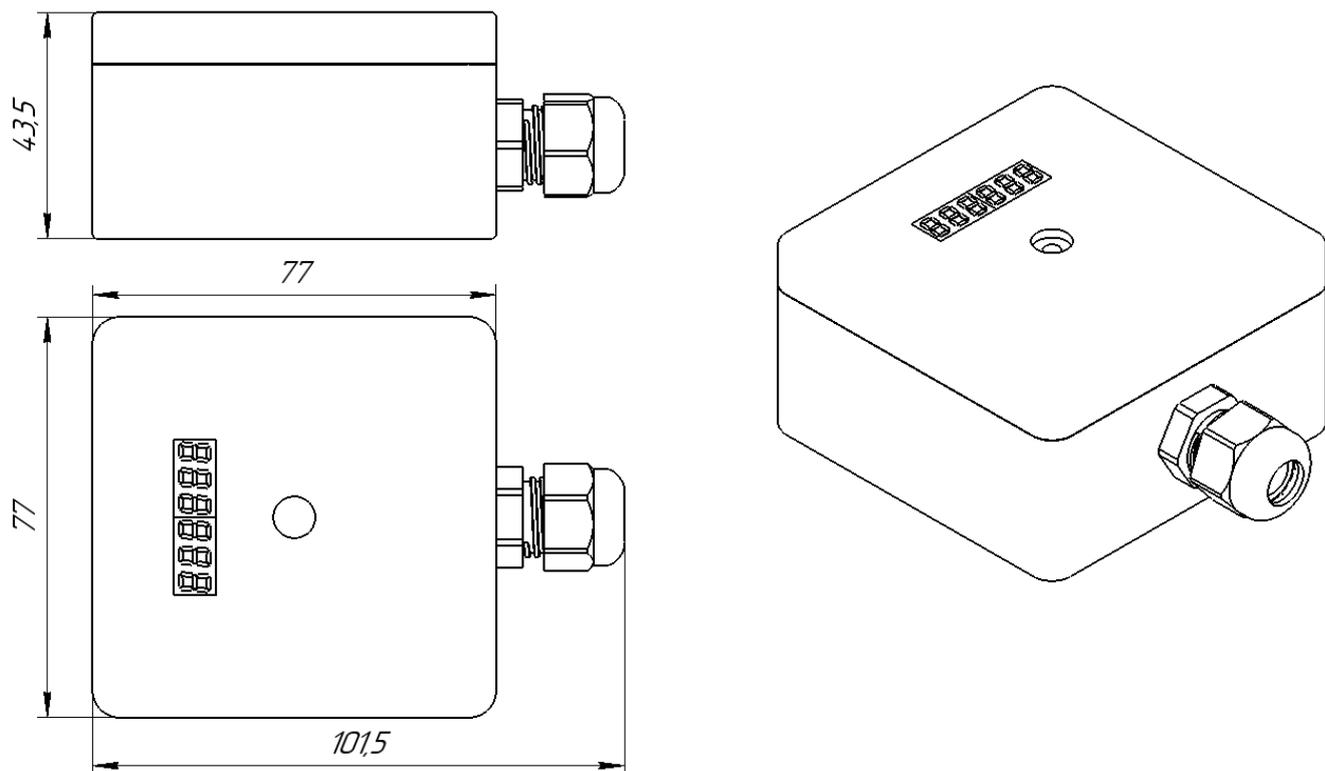
Рис. 1. Установочные размеры
