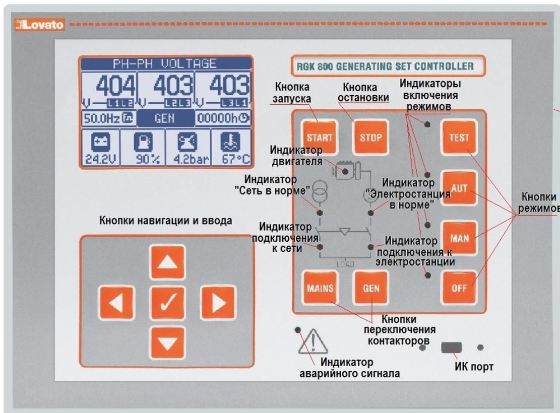
**Индикатор двигателя (зеленый)** – горит при работе двигателя; не горит, когда двигатель остановлен; моргает, когда двигатель находится в процессе последовательности запуска, при этом аварийная сигнализация основных параметров отключена
