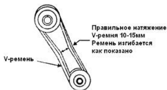
Рис. 2 Натяжение V-ремня
