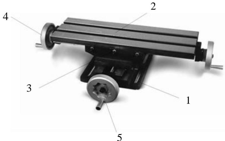
Стол предназначен для фрезерных, сверлильных, расточных и т.п. работ.
