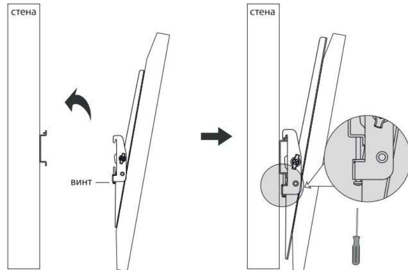
Затяните нижние болты, чтобы прикрепить монтажные планки к настенной пластине.
