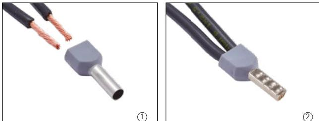
При необходимости опрессованная втулка может быть впоследствии обрезана по длине на глубину захода в контактное гнездо электрооборудования.
