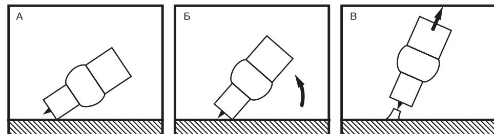
A. Поставьте керамическое сопло горелки на изделие, не касаясь при этом вольфрамом детали. Держите расстояние 2-3 мм. Откройте вентиль горелки.
