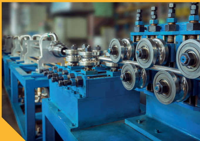
Линия охлаждения гофрированной трубы Stahlmann после отжига
