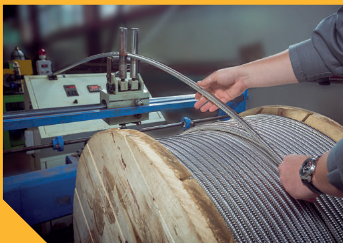
Подача гофрированной трубы Stahlmann для отжига
