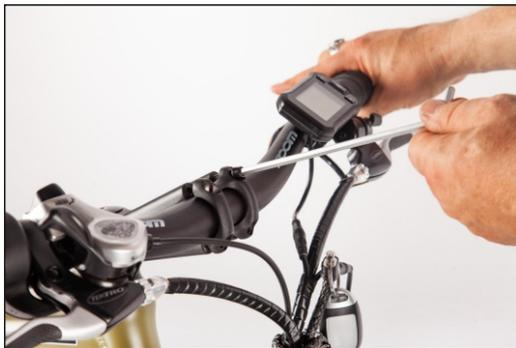
Еще раз проверьте параллельность оси выноса руля по переднему колесу велогибрида и затяните при помощи шестигранников болты крепления выноса.
