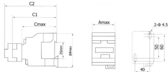
Рисунок 1 – Габаритные и присоединительные размеры пускателей 9 -12А
