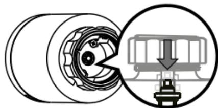
Толкатель должен находиться в одну линию с корпусом устройства.
