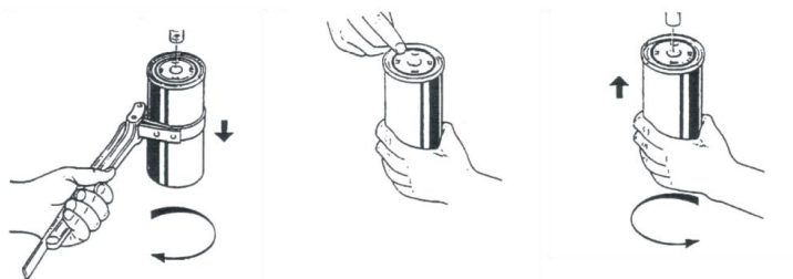
Рисунок 22 – Последовательность операций при замене фильтра масляного
