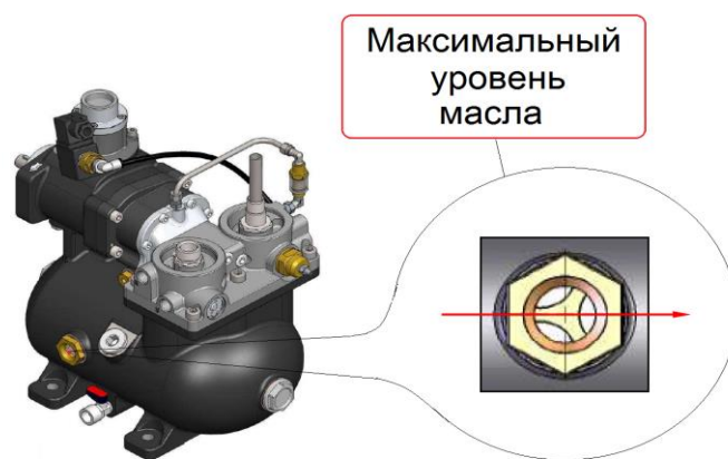
Рисунок 17 – Контроль уровня масла в компактном компрессорном модуле
