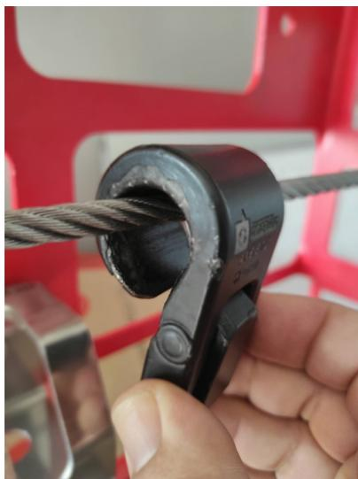
Рис. 12. Установка мобильной анкерной точки арт. AXS602 на тросе.
