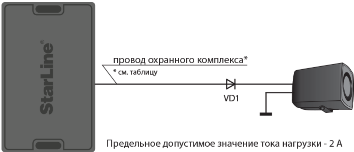
Схема подключения автомобильной сирены
