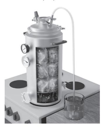
Установить автоклав на любой тип плит и установить фальшдно в корпус автоклава горизонтально ровно. Далее автоклав наполнить 5-ю литрами воды, чтобы уровень воды не скрывал фальшдно и нагревательный элемент (если он есть) был полностью погружен в воду, как показано на рисунке 3.
