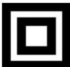
**Класс II** – Аппарат имеет двойную изоляцию. Использование заземляющего провода не требуется.
