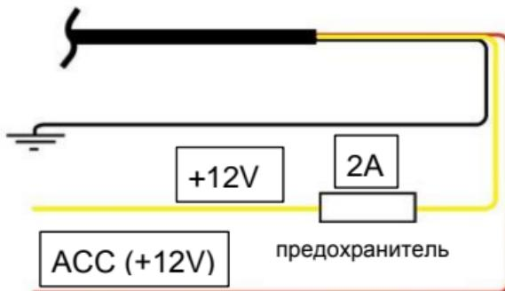
Желтый провод должен быть подключен максимально близко к проводам, идущим от плюсовой клеммы аккумулятора на блок предохранителей (так как в приборе реализован контроль питания батареи для защиты ее от разряда, желательно максимально исключить потери напряжения на участках цепи).
