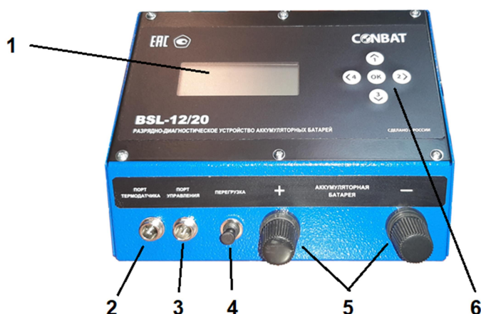
Рис 1. Внешний вид лицевой панели и органы управления РДУ «CONBAT»
